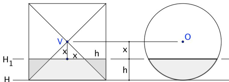
Pelo Princípio de Cavalieri o volume do segmento esférico de altura  $h$  em uma esfera de raio  $R$  é igual ao volume de um cilindro de raio  $R$  e altura  $h$  subtraído do volume de um tronco de cone de altura  $h$  cujas bases têm raios  $R$  e  $x$ .
